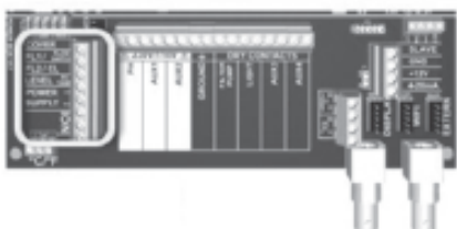
Připojení detektoru průtoku ke svorkám 2 a 5
